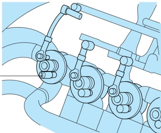
4-ю клавишу на модели YHR-567/567GDB можно отрегулировать в соответствии с размером и положением ладони музыканта.
