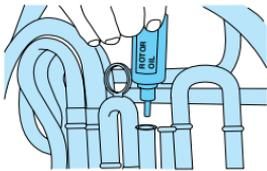
\* Во время нанесения масла, не допускайте смешивания масла со смазкой кроны, которая нанесена на внутреннюю часть кроны.
